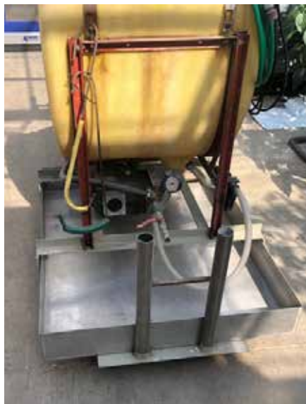
Montage av uppsamlingsbehållare under sprutan som möjliggör mobil, säker påfyllningsplats.
