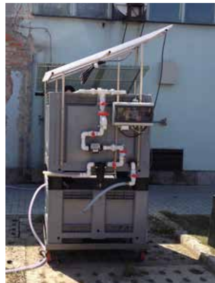
Exempel på slutet biofilter för omhändertagande av mindre mängder växtskydds-kontaminerat vatten.
