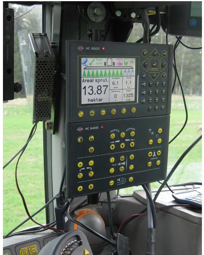
Avancerad sprutdator kopplad till GPS som möjliggör sektionsavstängning med GPS. I detta fall 13 sektioner varav 10 sprutar och 3 sektioner är stängda.
