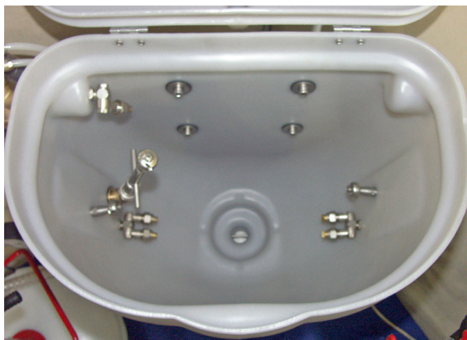
Preparatpåfyllare med färre inredningsdetaljer förbättrar tömning och rengöring.
