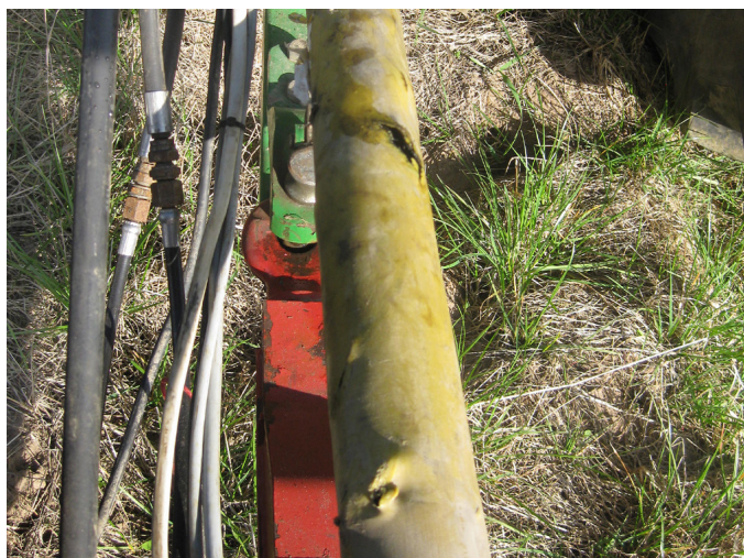
Skydd på kraftöverföringsaxel som behöver bytas ut eftersom hydraularmarna tagit i skyddet.
