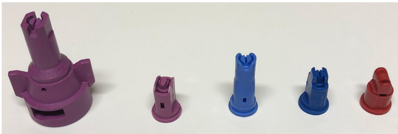
Det är viktigt att välja rätt spridare efter behov. Varje spridare har unika egenskaper och godkännande. Här ses några exempel på godkännande i olika klasser beroende på tryck. Från vänster: Teejet AIC 110-025 VP: 50 och 75 %, Lechler IDK T 120-025 POM: 50, 75 och 90 %, Lechler ID-120-03 POM: 50, 75 och 90 %, Teejet AIXR 120-03 VP: 50 % och Teejet AITTJ60-110-04: 50, 75 och 90 %.
