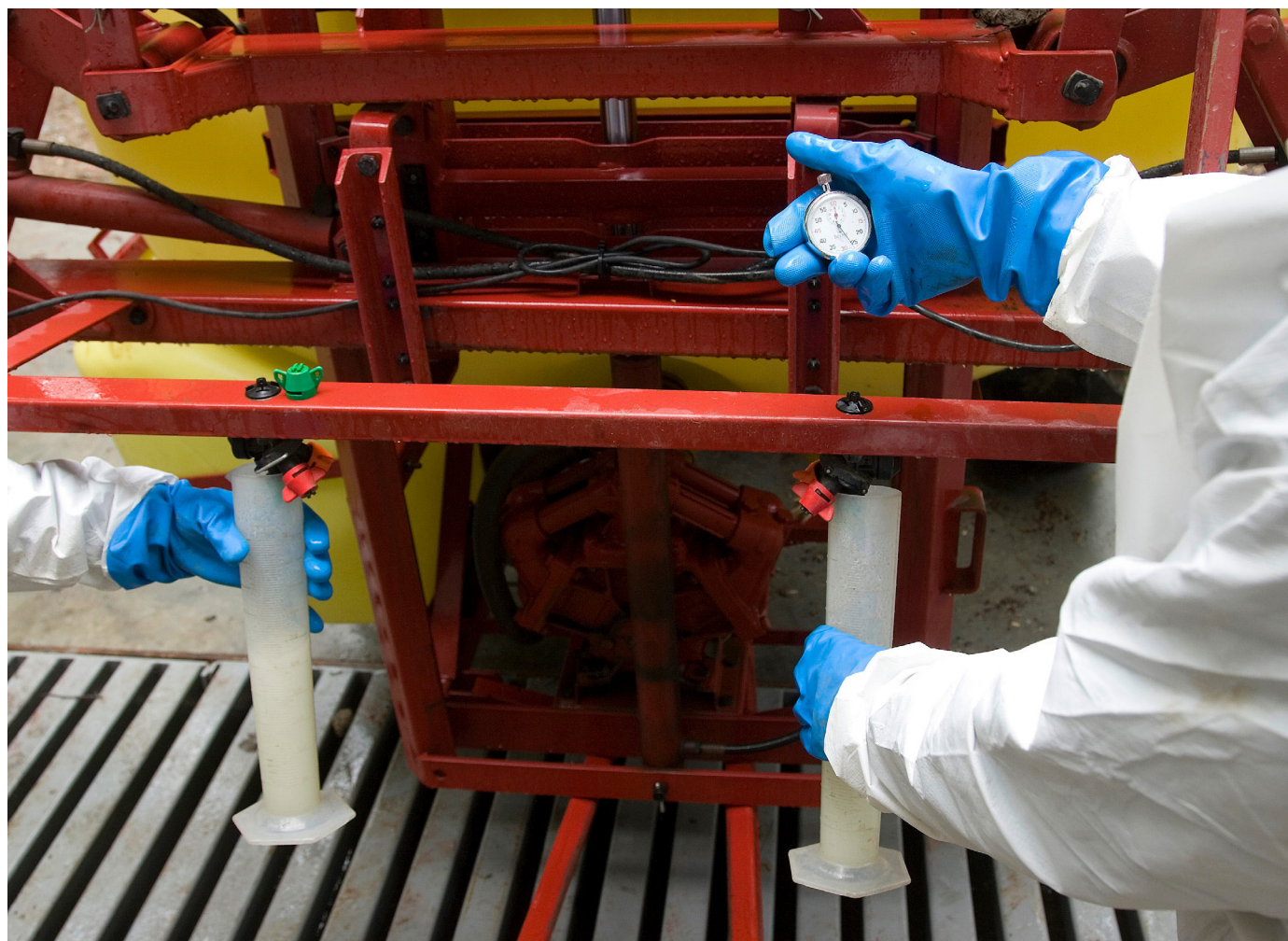
Kontroll av spridarnas flöde i l/min för kalibrering.
