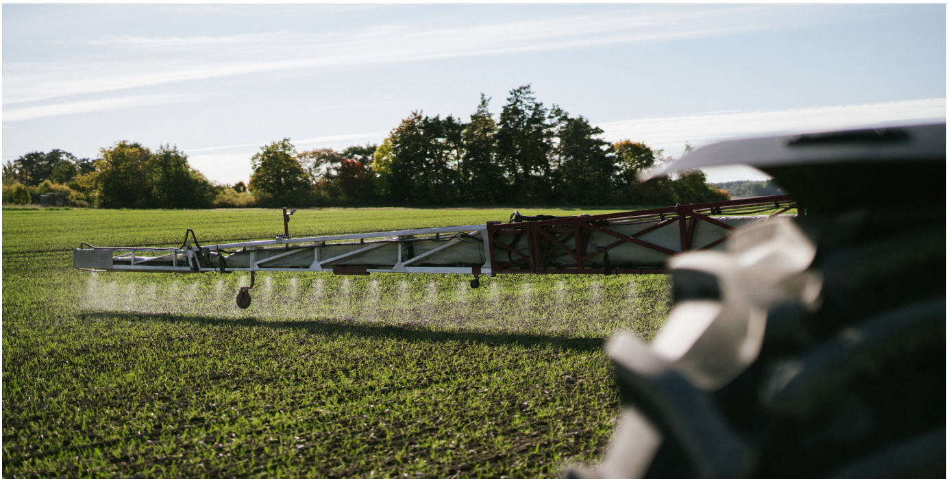
Det kan skilja mycket i duschkvalitet beroende på vilket material spridaren är tillverkad av. Duschkvaliteten kan också skilja mellan olika tillverkare på till synes likadana spridare.
