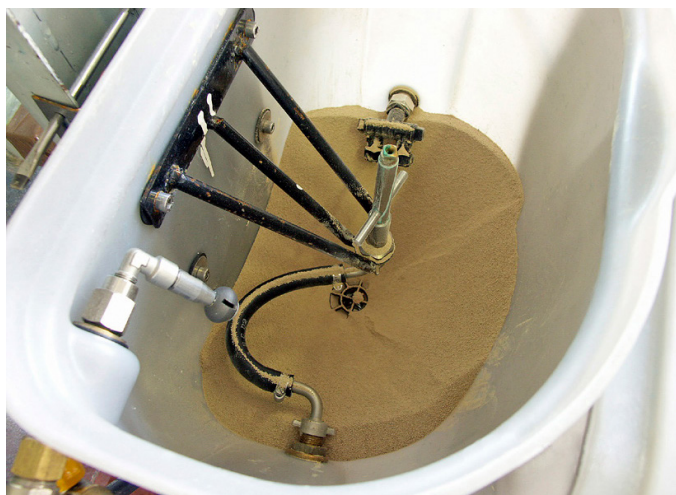
Preparatpåfyllare av äldre modell som lämnar kvar rester och är svår att rengöra.
