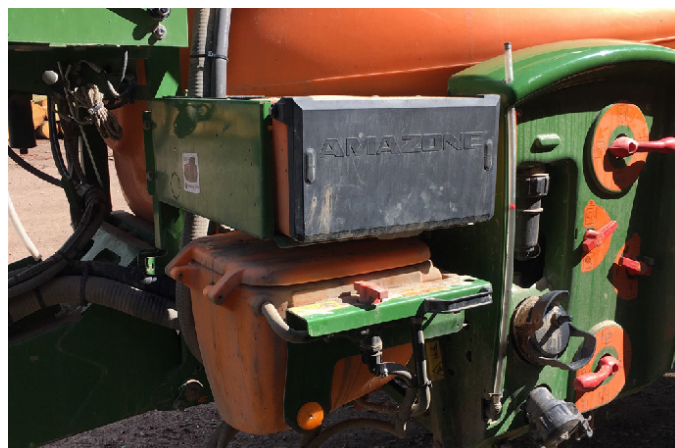
Preparatpåfyllare som är skyddad både ifrån ramp och hjul. Därtill en smidig förvaringsbox för skyddsutrustning ovanför.
