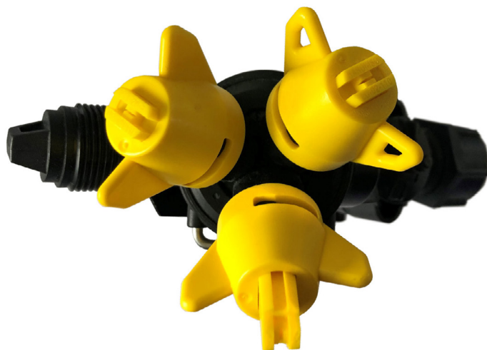
Tre varianter av spaltspridare, gul vanlig spaltspridare, gul Lowdrift-spridare och gul Minidrift injektorspridare. Alla spridare ger samma flöde vid samma tryck men olika duschkvalitéer. Ingen spridare i bilden klarar kraven på 50 % vindavdriftsreduktion.
