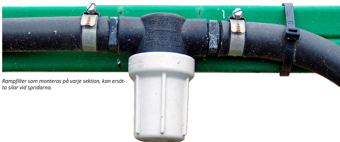
Tidigare har olika tillverkare haft olika färger för samma masktäthet, numera finns möjlighet att följa en ISO-standard för färgmärkning.
