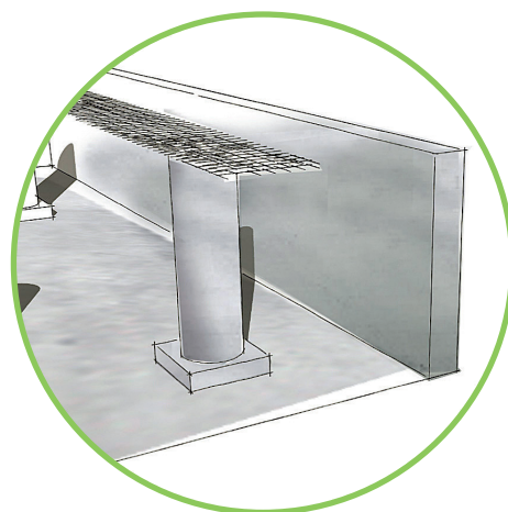
Körramp som bärs upp av plintar.
