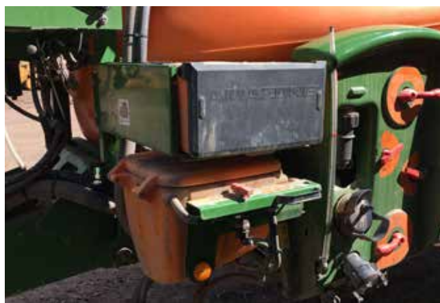
Preparatpåfillare som är mycket skyddad både ifrån ramp och hjul. Därtill en smidig förvaringsbox för skyddsutrustning ovanför.
