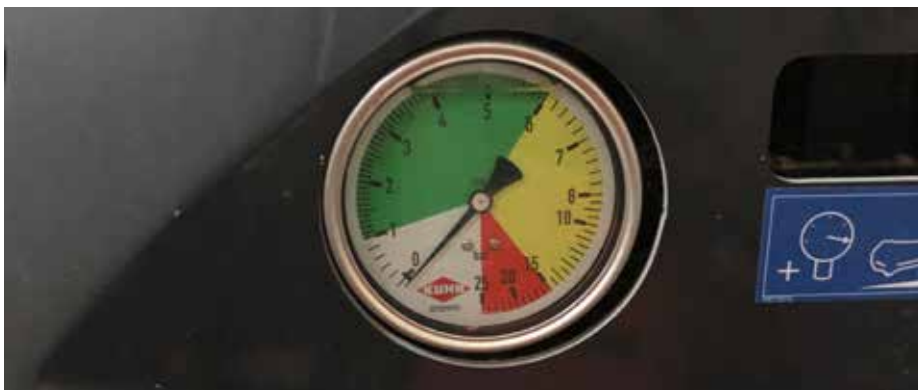
Manometer med tätgraderad skala mellan 1-6 bar.
