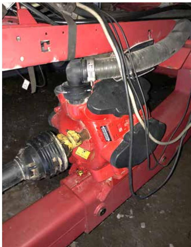
Membranpump med flera membran som behöver ses över emellanåt för att inte riskera att pumpen skadas.
