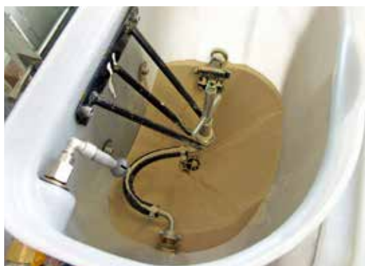
Preparatpåfillare av äldre modell som lämnar kvar rester och är svårare att rengöra.
