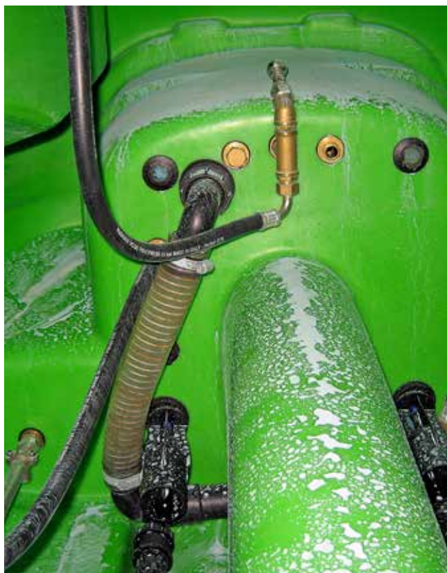
Rester på olika ställen i tanken tyder på otillräcklig omrörning.
