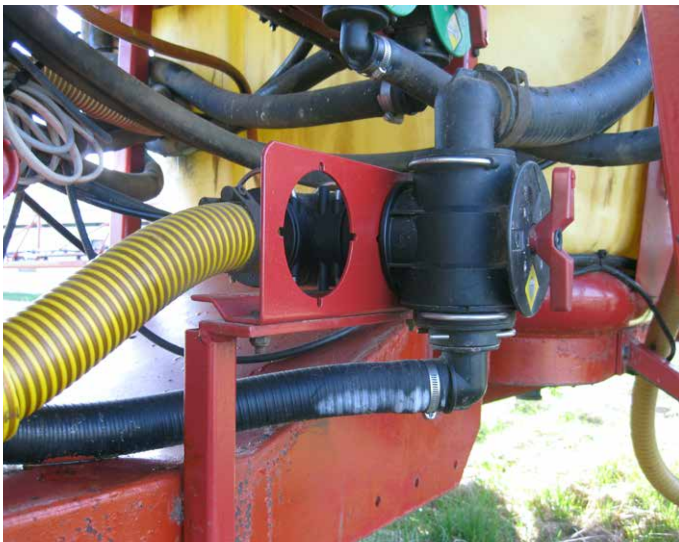
Deformerad slang, byt ut i tid!
