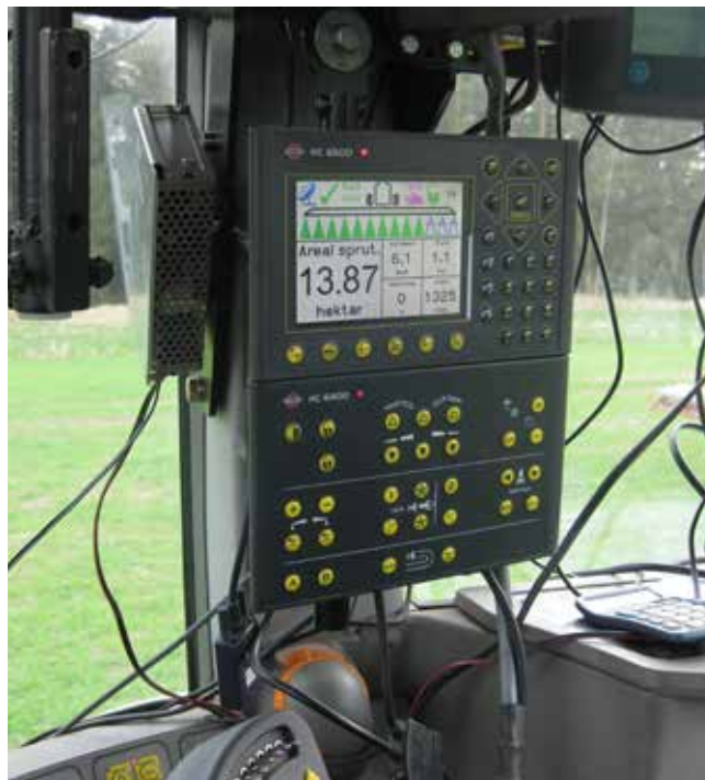
Avancerad sprutdator kopplad till GPS som möjliggör sektionsavstängning med GPS. I detta fall 13 sektioner varav 10 sprutar och 3 sektioner är stängda i bilden.
