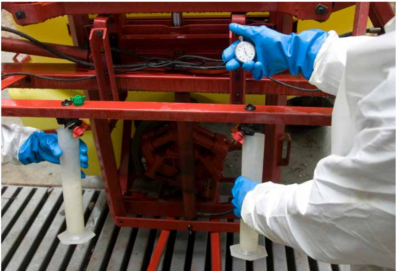
Kontroll av spridarnas flöde i l/min för kalibrering.
