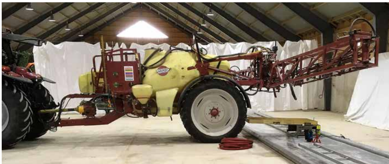
Ett funktionstest med s.k. sprayscanner
