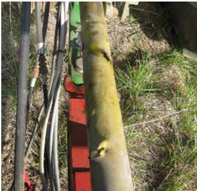
Skydd på kraftöverföringsaxel som behöver bytas ut eftersom hydraularmarna tagit i skyddet.
