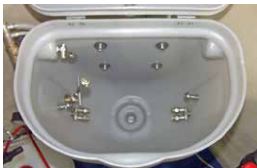
Preparatpåfillare med färre inredningsdetaljer förbättrar tömning och rengöring.
