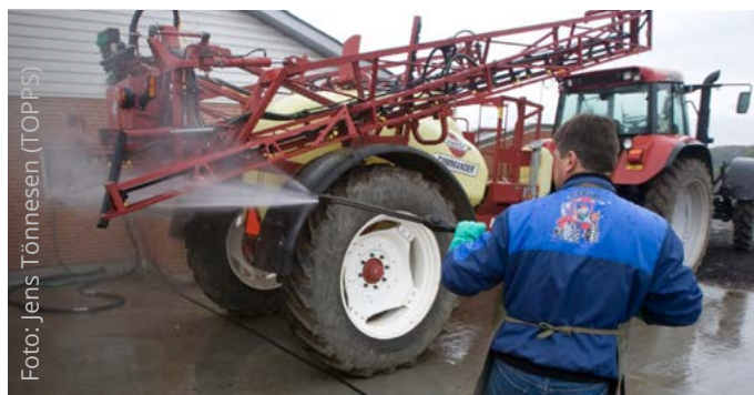
Utvändig tvätt av sprutan på platta med uppsamling.
