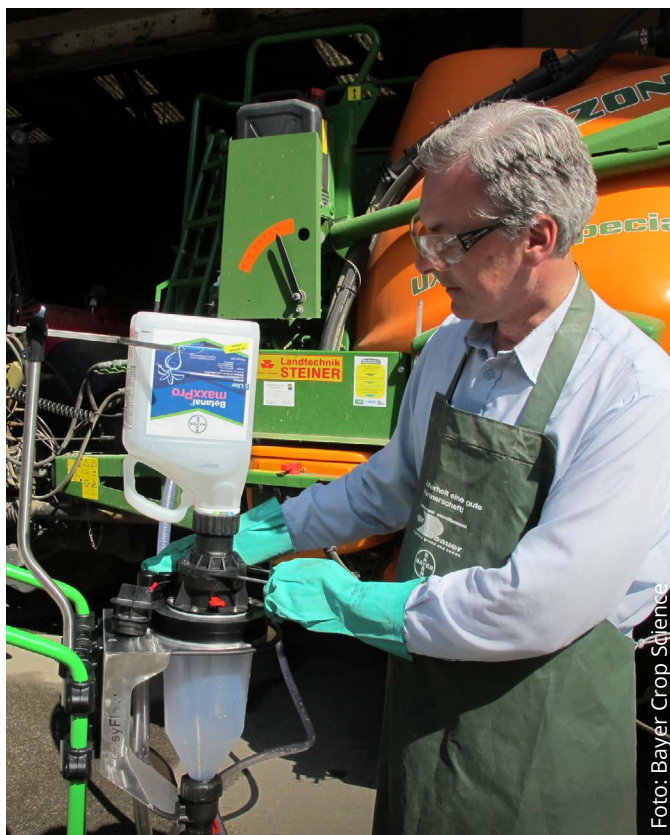
EasyFlow M, slutna påfyllning med uppmätning av påfylld mängd. En adapter för anslutning till CTS skruvas på förpackningen som har folieförsegling. Vid deltömning ska adaptern sitta kvar på dunken tills den är tömd och rengjord.
