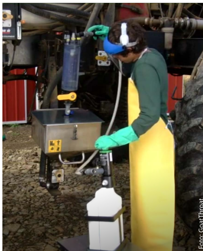
GoatThroat, slutna påfyllning med uppmätning av påfylld mängd i mätröret som ansluts på preparatpåfyllaren. En handpump som ansluts på dunken ger ett övertryck som tömmer dunken.
