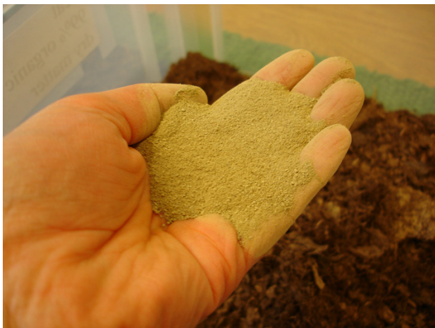
Ett spärrskikt i form av ett lerlager i botten av biobädden hindrar vatten att dränera ut alltför snabbt. Foto: HIR Skåne
