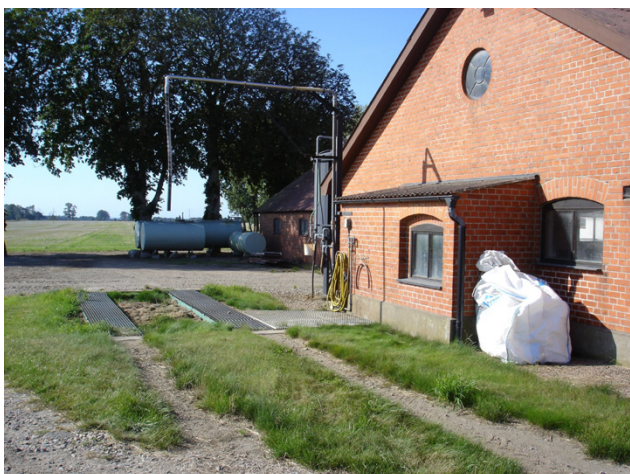
Plana ytor med gallerdurk där du står och fyller på sprutan minskar risken för olyckshändelser. Foto: EN
